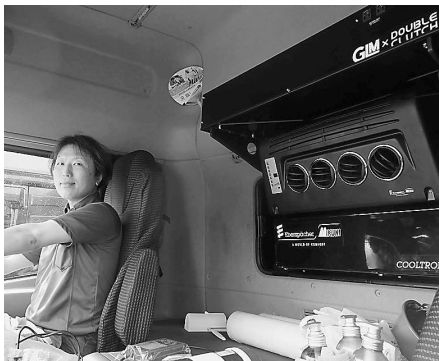
エースジャパンのトラックに導入している車載用サブバッテリーとクーラー
